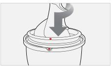
Hinweis | Die Presswalze muss richtig eingesetzt sein, damit der Einfüllschacht schließt.
