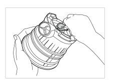
Die Silkondichtung lässt sich zur Reinigung herausnehmen. Setzen Sie die Dichtung wie auf dem Bild gezeigt wieder ein, achten Sie dabei auf korrekten Sitz.
