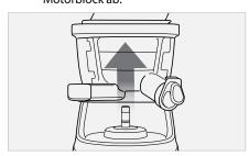
Entfernen Sie Presswalze, Sieb und Abstreifer aus dem Presswalzengehäuse. Reinigen Sie alles mit den mitgelieferten Bürsten.
