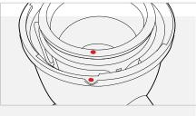
Stecken Sie die Presswalze in das Sieb und drücken / drehen Sie gleichzeitig, bis sie einrastet.
