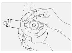
Tipp | • Die kleine, runde Bürste kann benutzt werden, um Trester- und Saftauslass zu reinigen.
