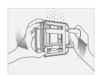
Spülen Sie dabei die Innen- und Außenseite des Siebes mit Wasser ab. Hartnäckige Fasern können mit der Reinigungsbürste eckig entfernt werden. Setzen Sie dazu auch das Griffende der Bürste ein!
