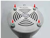
1. Lösen Sie die innen liegenden Schrauben der Standfüße und nehmen Sie diese mit den Fingern ab. Bei älteren Modellen sind die Standfüße nicht verschraubt, hier nehmen Sie erst die Standfüße ab und finden die zu lösenden Schrauben dann unter den Füßen.
